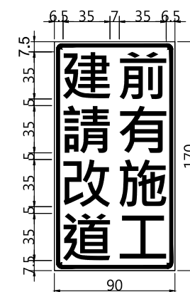
施工建請改道預告臨時牌面
