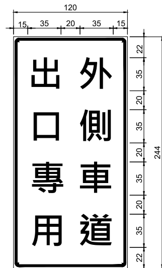
外側車道出口專用標誌 (B-B/Y) FT-6-21-1
