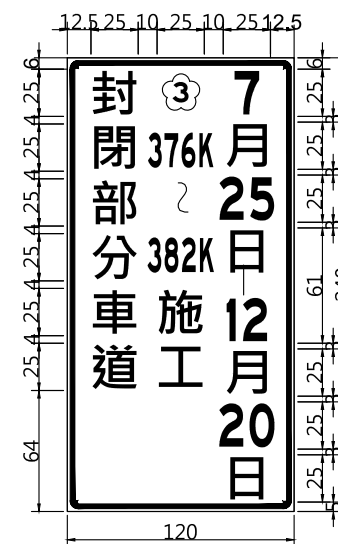
車道管制預告臨時牌面
